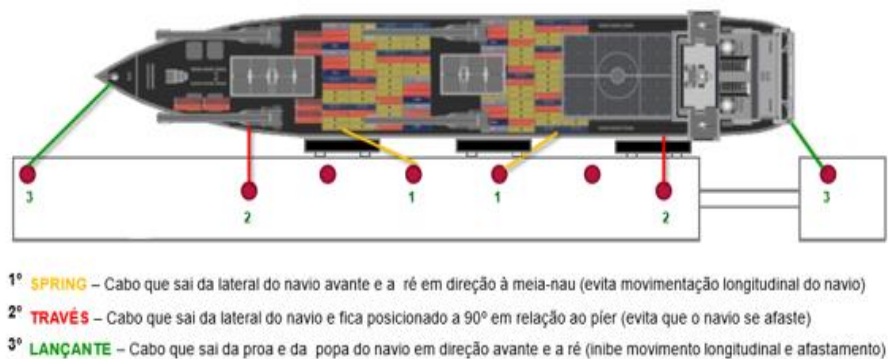
Figura 3.2 – Modelo de amarração do navio e os principais cabos de amarração (Adaptado de Vale, 2010)
