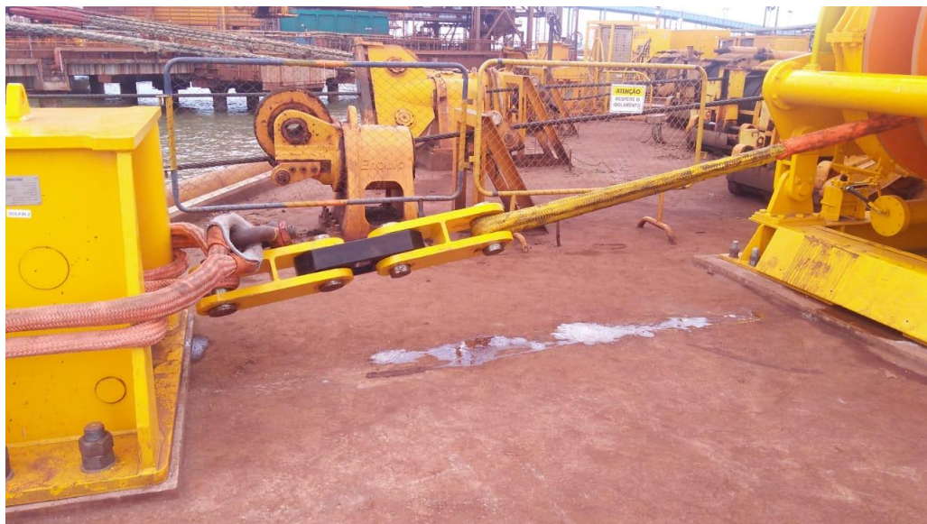
Figura 4.18 – Realização dos testes com carga do guincho (Elaborada pela autora, 2019)
