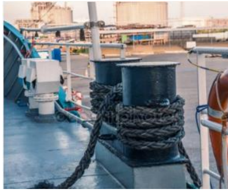
Figura 3.3 - Cabeço de amarração de um navio (Adaptado de Igor Kadasov, 2018)
