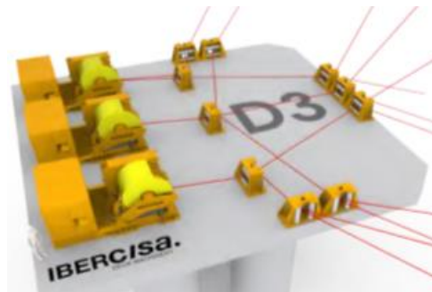
Figura 3.8 – Cabos do guincho direcionados pelos fairleads (Adaptado de Ibercisa, 2019)
