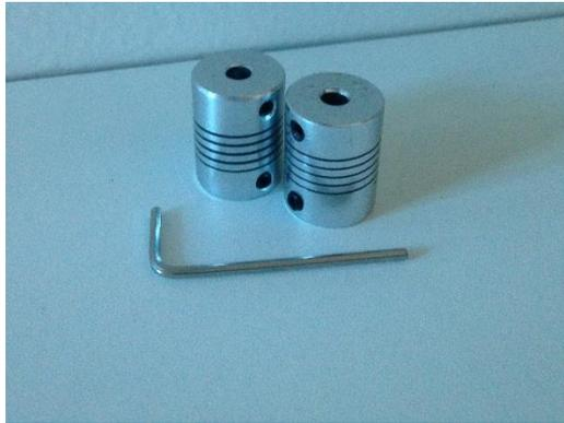
Figura 5.2 - Acoplamentos flexíveis 5x8mm. (Autor, 2019)
