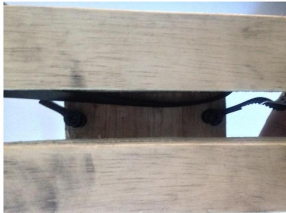
Figura 5.6 - Fixação da correia no suporte da extrusora. (Autor, 2019)
