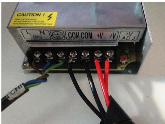
Figura 5.11 - Conexão da fonte chaveada. (Autor, 2019)
