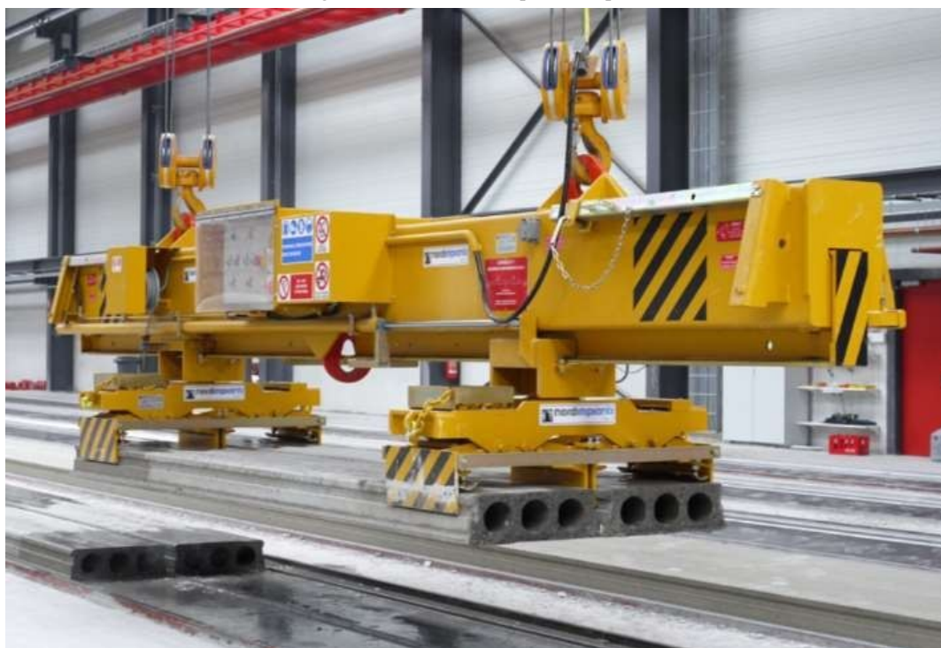
Figura 18 - Içamento do painel da pista
