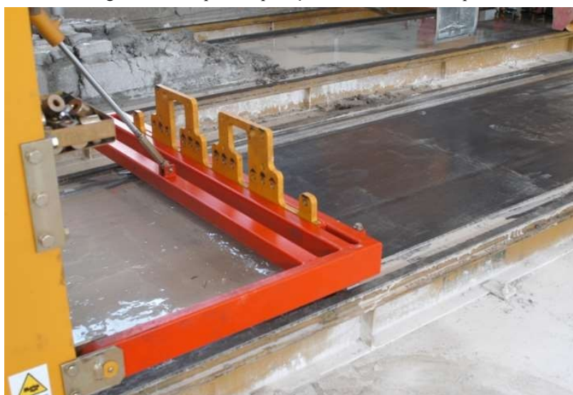
Figura 13 - Limpeza e aplicação do desmoldante na pista
