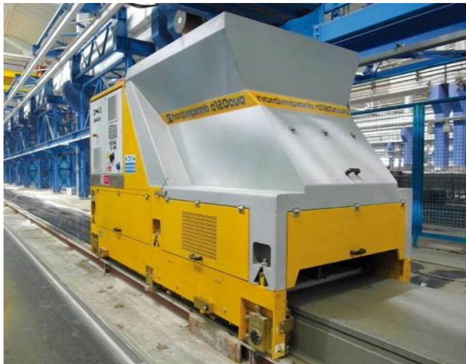
Figura 14 - Lançamento do concreto através da máquina extrusora
