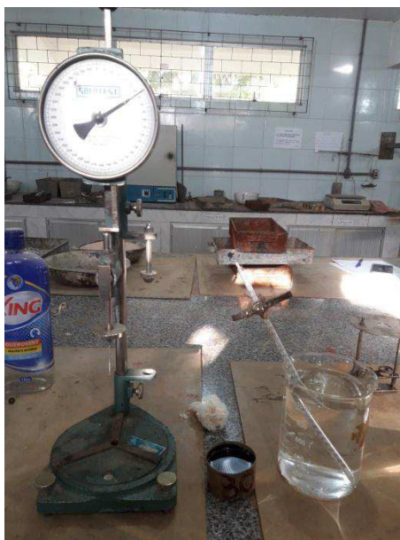
Figura 29- Equipamentos para ensaio de penetração
