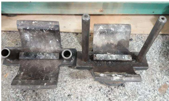
Figura 34- Molde para ensaio de RT com friso
