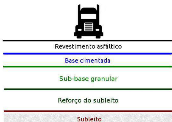
Figura 4- Estrutura de um pavimento semi-rígido
