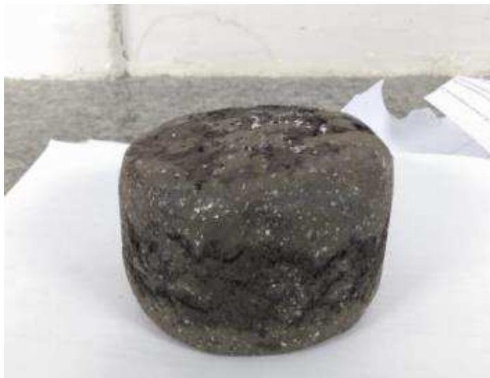
Figura 37- Corpo de prova pós ensaio cântabro
