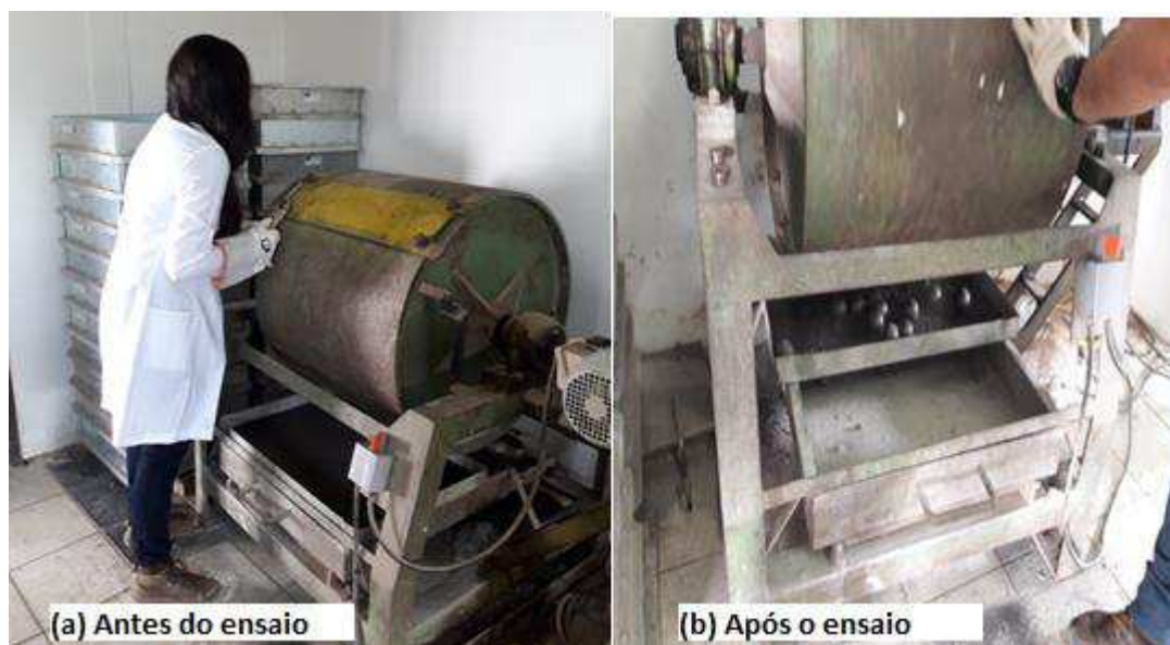
Figura 23 - Máquina de abrasão a "Los Angeles"
