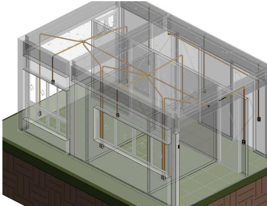
Figura 23 – Isométrico parcial das instalações elétricas
